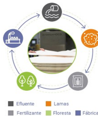
Projeto para a fabricação de fertilizante a partir das lamas secundárias da ETAR Biotek
